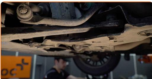
**7** Καθαρίστε τα στοιχεία στερέωσης των μπαρακιών της αντιστρεπτικής δοκού. Χρησιμοποιήστε μια συρματόβουρτσα. Χρησιμοποιήστε σπρέι WD-40.
