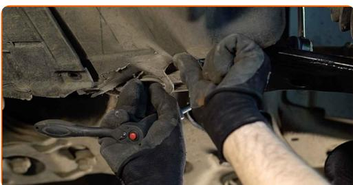
**20** Καθαρίστε το σημείο τοποθέτησης της ζάντας του τροχού. Χρησιμοποιήστε μια συρματόβουρτσα. Καθαρίστε το σημείο επαφής. Χρησιμοποιήστε γράσο χαλκού.
