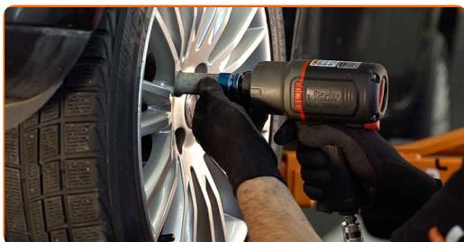
**23** Χαμηλώστε το αυτοκίνητο και χρησιμοποιήστε σταυρό, προκειμένου να σφίξετε τα μπουλόνια των τροχών. Χρησιμοποιήστε κρουστικό καρυδάκι για μπουλονόκλειδο No #17. Χρησιμοποιήστε ένα δυναμόκλειδο. Σφίξτε τη με ροπή 120 Nm.
