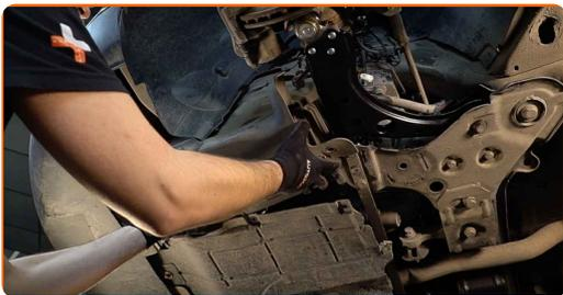
**19** Τοποθετήστε και σφίξτε τα στοιχεία στερέωσης του καλύμματος του θόλου του τροχού. Χρησιμοποιήστε ένα καρυδάκι #10. Χρησιμοποιήστε μια καστανία. Χρησιμοποιήστε ένα σταυροκατσάβιδο.
