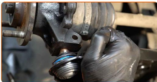
**54** Καθαρίστε τις βάσεις τοποθέτησης του ακρόμπαρου. Χρησιμοποιήστε μια συρματόβουρτσα. Χρησιμοποιήστε σπρέι WD-40.
