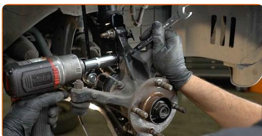
**21** Καθαρίστε όλα τα συνδετικά σημεία του ψαλιδιού. Χρησιμοποιήστε μια συρματόβουρτσα. Χρησιμοποιήστε σπρέι WD-40.
