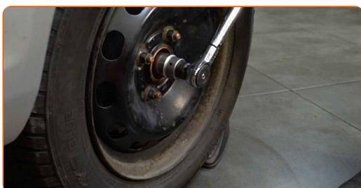
**78** Σφίξτε τα μπουλόνια του τροχού, σταυρωτά. Χρησιμοποιήστε κρουστικό καρυδάκι για μπουλονόκλειδο No #19. Χρησιμοποιήστε ένα δυναμόκλειδο. Σφίξτε τη με ροπή 110 Nm.
