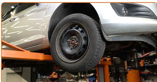
**77** Σφίξτε το παξιμάδι του άξονα κίνησης. Χρησιμοποιήστε ένα καρυδάκι #32. Χρησιμοποιήστε ένα δυναμόκλειδο. Σφίξτε τη με ροπή 235 Nm.
