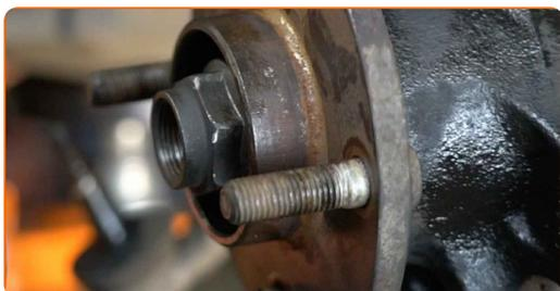
**52** Σφίξτε το παξιμάδι του άξονα κίνησης. Χρησιμοποιήστε ένα καρυδάκι #32. Χρησιμοποιήστε μια καστίνα.
