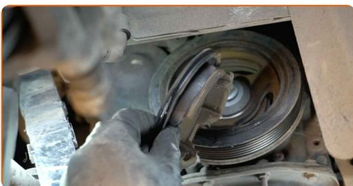
**33** Γυρίστε την τροχαλία ιμάντα. Χρησιμοποιήστε ένα καρυδάκι #18. Χρησιμοποιήστε μια καστάνια.
