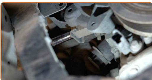
**32** Βγάλτε το καπάκι της τροχαλίας του στροφαλοφόρου άξονα. Χρησιμοποιήστε ένα ίσιο κατσαβίδι.
