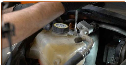
**53** Αφαιρέστε το δοχείο διαστολής του ψυγείου.
