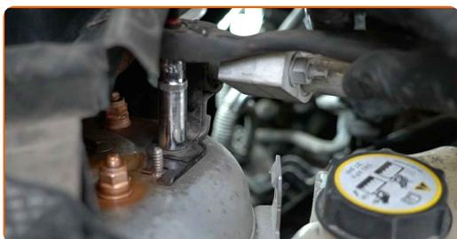
**52** Βγάλτε τα στοιχεία συγκράτησης δοχείου διαστολής ψυκτικού. Χρησιμοποιήστε ένα εργαλείο αφαίρεσης κλιπ.
