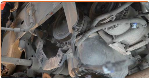
**31** Ξεβιδώστε τα στοιχεία στερέωσης του βραχίονα στήριξης της καλωδίωσης του κινητήρα. Χρησιμοποιήστε ένα καρυδάκι #8. Χρησιμοποιήστε μια καστάνια.
