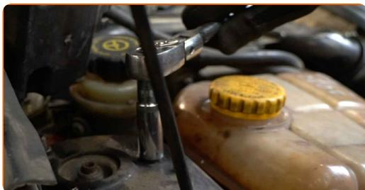
**6** Καθαρίστε το στοιχείο στερέωσης του άξονα κίνησης. Χρησιμοποιήστε μια συρματόβουρτσα. Χρησιμοποιήστε σπρέι WD-40.
