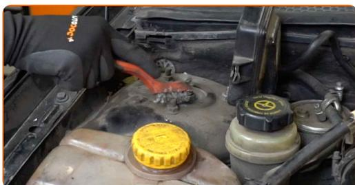
**5** Ξεσφίξτε τα επάνω στοιχεία στερέωσης του γόνατου ανάρτησης (3 κομμάτια). Χρησιμοποιήστε ένα καρυδάκι #13. Χρησιμοποιήστε μια καστάνια.
