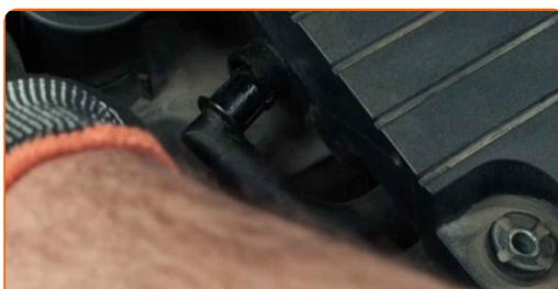
5 Αφαιρέστε τη σωλήνα της εισαγωγής αέρα.
