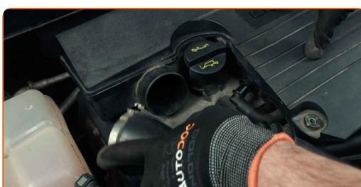
6 Ξεβιδώστε τις βίδες του κουτιού του φίλτρου. Χρησιμοποιήστε ένα καρυδάκι #10. Χρησιμοποιήστε μια καστάνια.
