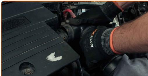
4 Βγάλτε το κολάρο του σωλήνα της εισαγωγής αέρα. Κάντε χρήση μιας πένσας σφιγκτήρων clic-R.
