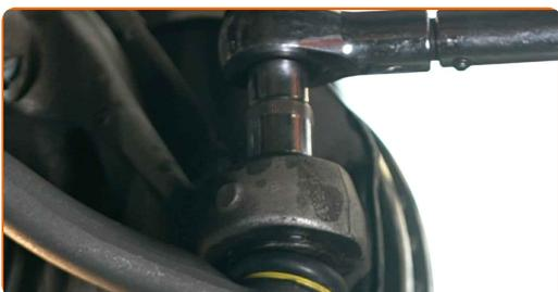
**17** Σφίξτε το παξιμάδι σύνδεσης του μπαλακιού με το ακρόμπαρο. Χρησιμοποιήστε ένα γερμανοπολύγωνο #19. Χρησιμοποιήστε ένα γερμανοπολύγωνο #22. Χρησιμοποιήστε ένα δυναμόκλειδο. Σφίξτε τη με ροπή 63 Nm.
