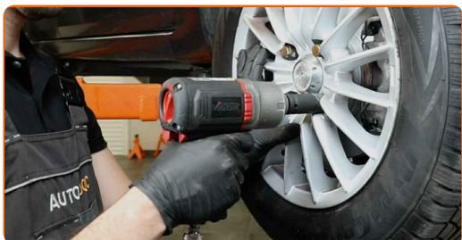
**23** Χαμηλώστε το αυτοκίνητο και χρησιμοποιήστε σταυρό, προκειμένου να σφίξετε τα μπουλόνια των τροχών. Χρησιμοποιήστε κρουστικό καρυδάκι για μπουλονόκλειδο No #19. Χρησιμοποιήστε ένα δυναμόκλειδο. Σφίξτε τη με ροπή 95 Nm.
