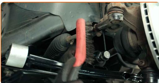
**7** Ξεβιδώστε το παξιμάδι του μπαλακιού στο μουαγιέ. Χρησιμοποιήστε ένα καρυδάκι #15. Χρησιμοποιήστε μια μανέλα κολαούζου.
