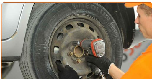
**30** Χαμηλώστε το αυτοκίνητο και χρησιμοποιήστε σταυρό, προκειμένου να σφίξετε τα μπουλόνια των τροχών. Χρησιμοποιήστε κρουστικό καρυδάκι για μπουλονόκλειδο No #19. Χρησιμοποιήστε ένα δυναμόκλειδο. Σφίξτε τη με ροπή 120 Nm.
