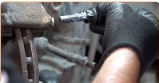
**23** Σφίξτε τα στοιχεία στερέωσης της δαγκάνας του φρένου. Χρησιμοποιήστε ένα Άλεν Νο.Η7. Χρησιμοποιήστε ένα δυναμόκλειδο. Σφίξτε τη με ροπή 35 Nm.
