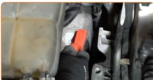
**13** Τοποθετήστε τη βάση του κινητήρα στο σημείο τοποθέτησής της.
