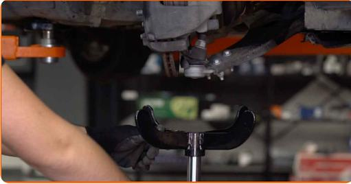
**22** Απελευθερώστε το κάτω στοιχείο στερέωσης που συνδέει το γόνατο του αμορτισέρ με το mouagié. Χρησιμοποιήστε ένα ειδικό καρυδάκι για να βγάλετε το αμορτισέρ. Χρησιμοποιήστε ένα σφυρί. Χρησιμοποιήστε ένα ίσιο σκαρπέλο μετάλλου.
