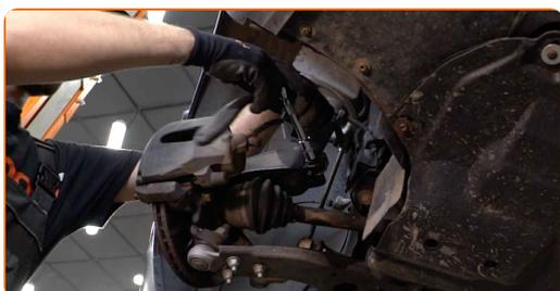
**21** Στηρίξτε το mouagié. Χρησιμοποιήστε ένα υδραυλικό γρύλο σασμάν.
