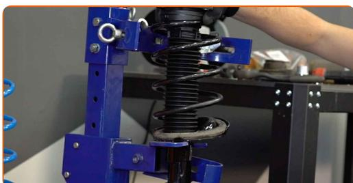
**38** Καθαρίστε τις βάσεις τοποθέτησης του γόνατου του αμορτισέρ. Χρησιμοποιήστε μια συρματόβουρτσα. Χρησιμοποιήστε σπρέι WD-40.
