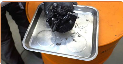
**12** Ξεβιδώστε τα στοιχεία στερέωσης του καλύμματος του περιβλήματος του φίλτρου αέρα. Χρησιμοποιήστε ένα Τορξ T15. Χρησιμοποιήστε μια καστάνια.
