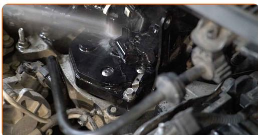
**26** Βιδώστε τις βίδες στερέωσης της βάσης του φίλτρου καυσίμου. Χρησιμοποιήστε ένα καρυδάκι #8. Χρησιμοποιήστε μια καστάνια.
