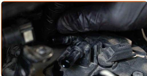
**9** Χαλαρώστε τη βάση του φίλτρου καυσίμου. Χρησιμοποιήστε ένα καρυδάκι #8. Χρησιμοποιήστε μια καστάνια.
