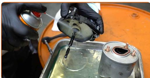
**15** Τοποθετήστε και σφίξτε το καπάκι του κουτιού του φίλτρου καυσίμου. Χρησιμοποιήστε ένα Τορξ T15. Χρησιμοποιήστε μια κασάνια.
