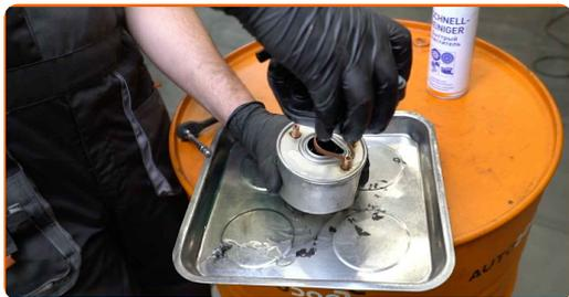
**14** Καθαρίστε το περίβλημα και το καπάκι του φίλτρου καυσίμου. Χρησιμοποιήστε ένα σπρέι καθαρισμού γενικής χρήσης.
