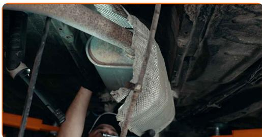
**14** Καθαρίστε το στοιχείο στερέωσης της ντίζας του χειρόφρενου. Χρησιμοποιήστε σπρέι WD-40.
