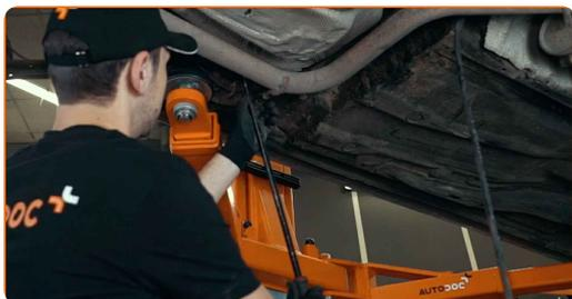
**9** Στηρίξτε το σιλανσιέ. Χρησιμοποιήστε ένα υδραυλικό γρύλο σασμάν.
