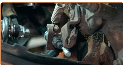
**22** Ρυθμίστε την τάνυση της ντίζας του χειρόφρενου. Χρησιμοποιήστε ένα καρυδάκι #16. Χρησιμοποιήστε μια κασάνια.
