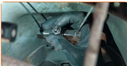
**16** Ελευθερώστε τη ντίζα του χειρόφρενου. Χρησιμοποιήστε ένα μυτοσίμπιδο.
