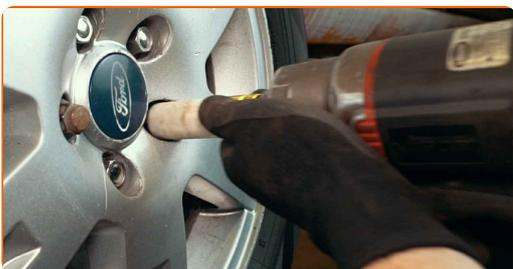
**33** Χαμηλώστε το αυτοκίνητο και χρησιμοποιήστε σταυρό, προκειμένου να σφίξετε τα μπουλόνια των τροχών. Χρησιμοποιήστε κρουστικό καρυδάκι για μπουλονόκλειδο Νο #19. Χρησιμοποιήστε ένα δυναμόκλειδο. Σφίξτε τη με ροπή 90 Nm.
