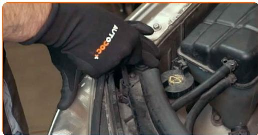
**35** Τοποθετήστε τη μάσκα ψυγείου.
