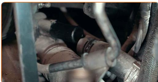
**20** Καθαρίστε το περίβλημα του θερμοστάτη. Χρησιμοποιήστε ένα σπρέι καθαρισμού γενικής χρήσης.
