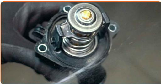
**25** Επεξεργαστείτε το περίβλημα του θερμοστάτη. Χρησιμοποιήστε ένα στεγανοποιητικό υλικό.
