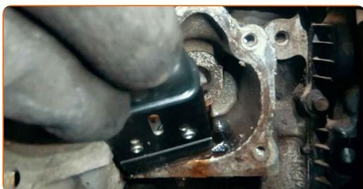
**24** Καθαρίστε το περίβλημα του θερμοστάτη. Χρησιμοποιήστε ένα σπρέι καθαρισμού γενικής χρήσης.
