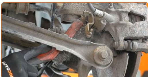
**8** Ελευθερώστε τη ντίζα του χειρόφρενου. Χρησιμοποιήστε κοφτάκι. Χρησιμοποιήστε ένα λοστό.
