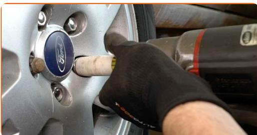
**24** Χαμηλώστε το αυτοκίνητο και χρησιμοποιήστε σταυρό, προκειμένου να σφίξετε τα μπουλόνια των τροχών. Χρησιμοποιήστε κρουστικό καρυδάκι για μπουλονόκλειδο Νο #19. Χρησιμοποιήστε ένα δυναμόκλειδο. Σφίξτε τη με ροπή 90 Nm.
