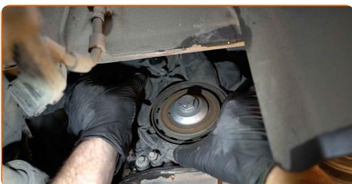
**101** Σφίξτε τα στοιχεία στερέωσης του κάτω καλύμματος του συστήματος χρονισμού. Χρησιμοποιήστε ένα καρυδάκι #7. Χρησιμοποιήστε ένα δυναμόκλειδο. Σφίξτε τη με ροπή 6 Nm.
