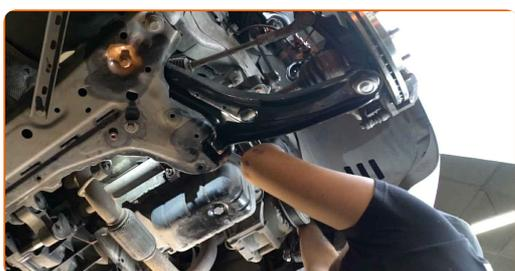
**131** Βιδώστε το στοιχείο στερέωσης της καλωδίωσης του δυναμό. Χρησιμοποιήστε ένα καρυδάκι #13. Χρησιμοποιήστε μια καστάνια.
