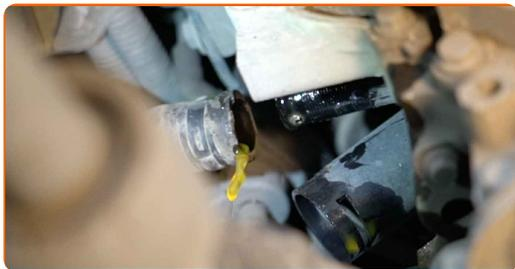
**51** Ξεβιδώστε τα στοιχεία στερέωσης της βάσης στήριξης σωληνώσεων του κλιματιστικού. Χρησιμοποιήστε ένα καρυδάκι #10. Χρησιμοποιήστε μια καστανία.
