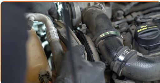
**9** Ξεβιδώστε τα στοιχεία στερέωσης του κάτω καλυμματος του σπειροειδή ιμάντα (ιμάντα poly-V). Χρησιμοποιήστε ένα Τορξ T30. Χρησιμοποιήστε μια καστίνα.
