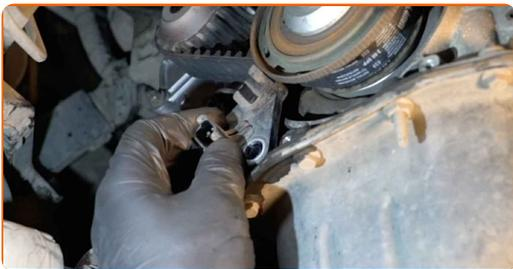
**99** Σφίξτε το στοιχείο στερέωσης του αισθητήρα θέσης του στροφαλοφόρου άξονα. Χρησιμοποιήστε ένα καρυδάκι #8. Χρησιμοποιήστε ένα δυναμόκλειδο. Σφίξτε τη με ροπή 9 Nm.
