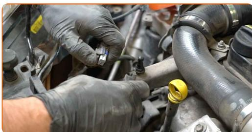
**21** Ξεβιδώστε τα στοιχεία στερέωσης του βραχίονα στήριξης της καλωδίωσης του κινητήρα. Χρησιμοποιήστε ένα καρυδάκι #10. Χρησιμοποιήστε μια καστίνα.
