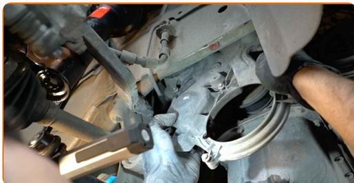
**39** Ξεβιδώστε τα στοιχεία στερέωσης του αισθητήρα θέσης του στροφαλοφόρου άξονα. Χρησιμοποιήστε ένα καρυδάκι #8. Χρησιμοποιήστε μια κασάνια.
