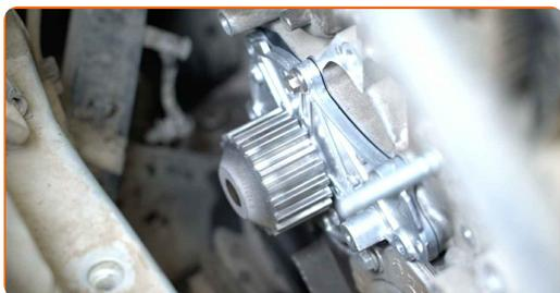
**76** Σφίξτε τα μέσα στερέωσης της αντλίας νερού. Χρησιμοποιήστε ένα καρυδάκι #8. Χρησιμοποιήστε ένα δυναμόκλειδο. Σφίξτε τη με ροπή 10 Nm.
