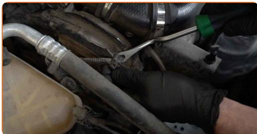
**7** Ξεβιδώστε τα στοιχεία στερέωσης του πάνω καλύμματος συστήματος χρονισμού. Χρησιμοποιήστε ένα καρυδάκι #7. Χρησιμοποιήστε μια καστανία.
