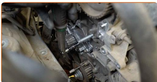
**77** Εφαρμόστε τη βίδες στερέωσης. Χρησιμοποιήστε ένα στεγανοποιητικό υλικό.
