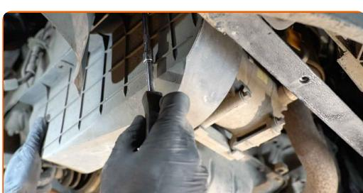
**16** Σφίξτε τα στοιχεία στερέωσης του κάτω καλύμματος του κάρτερ λαδιού. Χρησιμοποιήστε ένα Τορξ T30. Χρησιμοποιήστε μια καστάνια.
