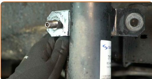
**25** Ξεβιδώστε το παξιμάδι του άξονα. Χρησιμοποιήστε ένα καρυδάκι 36 mm. Χρησιμοποιήστε μια καστάνια.
