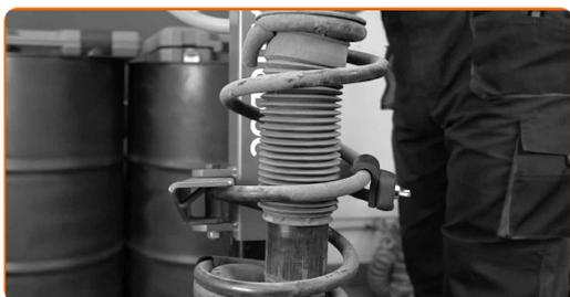
**51** Καθαρίστε το επάνω μέρος της ράβδου του εμπόλου του γόνατου. Χρησιμοποιήστε μια συρματόβουρτσα. Χρησιμοποιήστε σπρέι WD-40.
