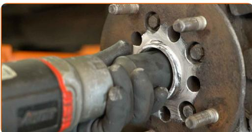
**26** Αφαιρέστε τη ροδέλα του άξονα. Χρησιμοποιήστε έναν τηλεσκοπικό μαγνήτη.
