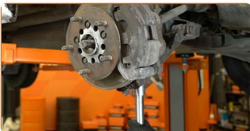
**28** Αποσυνδέστε τον άξονα μετάδοσης από το ακραξόνιο. Χρησιμοποιήστε έναν κυλινδρικό ζουμπά. Χρησιμοποιήστε ένα σφυρί.
