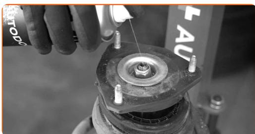
**52** Ξεβιδώστε το παξιμάδι της ράβδου του εμπόλου του γόνατου. Χρησιμοποιήστε ένα καρυδάκι για παξιμάδι αμορτισέρ 18 mm. Χρησιμοποιήστε μια εξάγωνη προέκταση H6. Χρησιμοποιήστε μια κασάνια.
