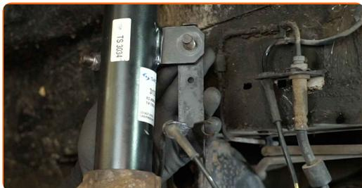
**76** Σφίξτε το στοιχείο στερέωσης που συνδέει το μπαράκι ζαμφόρ της αντιστρεπτικής δοκού με το γόνατο της ανάρτησης. Χρησιμοποιήστε ένα καρυδάκι 19 mm. Χρησιμοποιήστε ένα δυναμόκλειδο. Ροπή σύσφιξης: 55 Nm.
