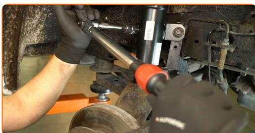
**77** Σφίξτε τον στοιχείο στερέωσης της βάσης του καλωδίου του αισθητήρα ABS. Χρησιμοποιήστε ένα καρυδάκι 18 mm. Χρησιμοποιήστε ένα δυναμόκλειδο. Ροπή σύσφιξης: 45 Nm.
