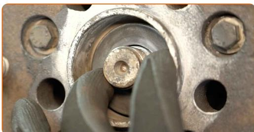
**71** Βιδώστε το παξιμάδι του άξονα. Χρησιμοποιήστε ένα καρυδάκι 36 mm. Χρησιμοποιήστε μια κασάνια.
