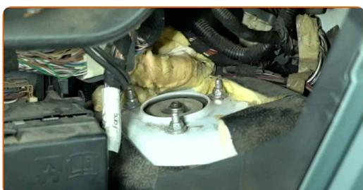
**6** Καθαρίστε τα στοιχεία στερέωσης της άνω βάσης γονάτου ανάρτησης. Χρησιμοποιήστε μια συρματόβουρτσα. Χρησιμοποιήστε σπρέι WD-40.
