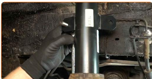
**75** Τοποθετήστε τη βάση του καλωδίου του αισθητήρα ABS και βιδώστε το παξιμάδι στερέωσης.
