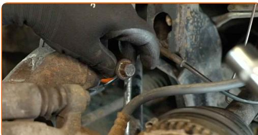
**42** Αποσυνδέστε το ακραξόνιο από το γόνατο της ανάρτησης. Χρησιμοποιήστε μία λαστιχένια ματσόλα. Χρησιμοποιήστε έναν γρύλο σασμάν ή έναν ακόμη γρύλο οχήματος.
