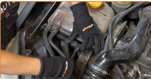
**4** Βγάλτε τα στοιχεία συγκράτησης δοχείου διαστολής ψυκτικού. Χρησιμοποιήστε ένα ίσιο κατσαβίδι.
