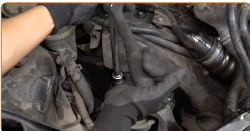
**9** Ξεβιδώστε τα στοιχεία στερέωσης που συνδέουν τη βάση κινητήρα στο αμάξωμα. Χρησιμοποιήστε ένα καρυδάκι #16. Χρησιμοποιήστε μια καστίνα.
