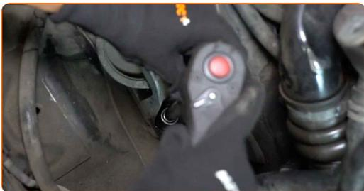
**10** Αφαιρέστε τη βάση του κινητήρα.
