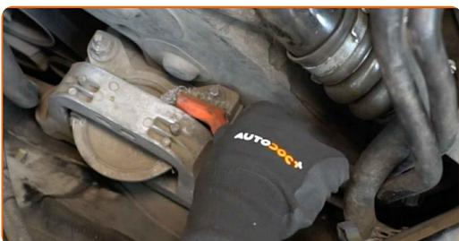
**8** Ξεβιδώστε το επάνω στοιχείο στερέωσης της βάσης του κινητήρα. Χρησιμοποιήστε ένα καρυδάκι #16. Χρησιμοποιήστε μια καστίνα.
