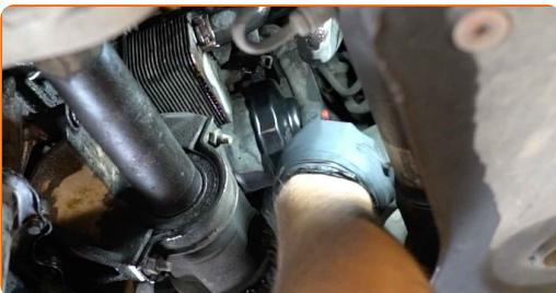
11 Ετοιμάστε ένα δοχείο για το παλιό φίλτρο λαδιού. Βάλτε το παλιό φίλτρο λαδιού στο δοχείο.
