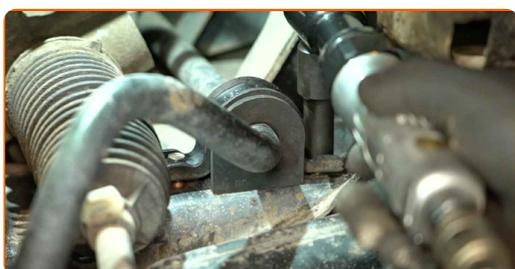
**22** Σφίξτε τα στοιχεία στερέωσης και στις δύο βάσεις του σινεμπλόκ της αντιστρεπτικής δοκού. Χρησιμοποιήστε ένα καρυδάκι 10 mm. Χρησιμοποιήστε ένα δυναμόκλειδο. Ροπή σύσφιξης: 25 Nm.
