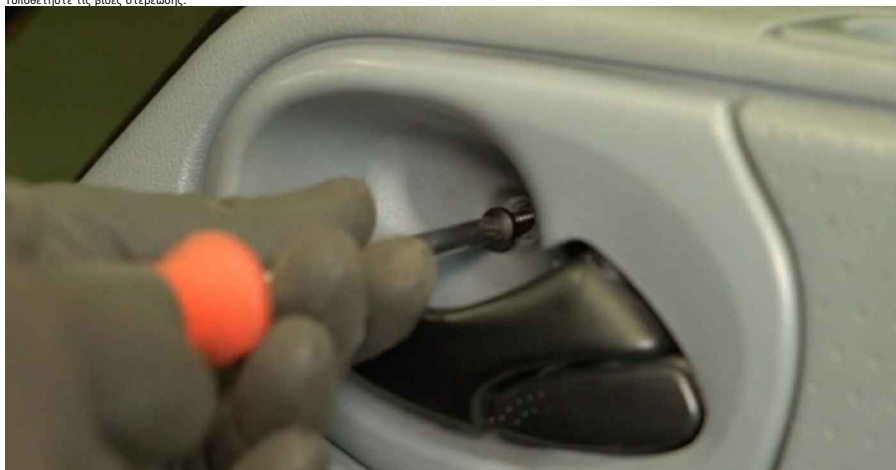
42 Σφίξτε τα στοιχεία στερέωσης της ταπεταρίας της πόρτας. Χρησιμοποιήστε ένα σταυροκατάβιδο.
