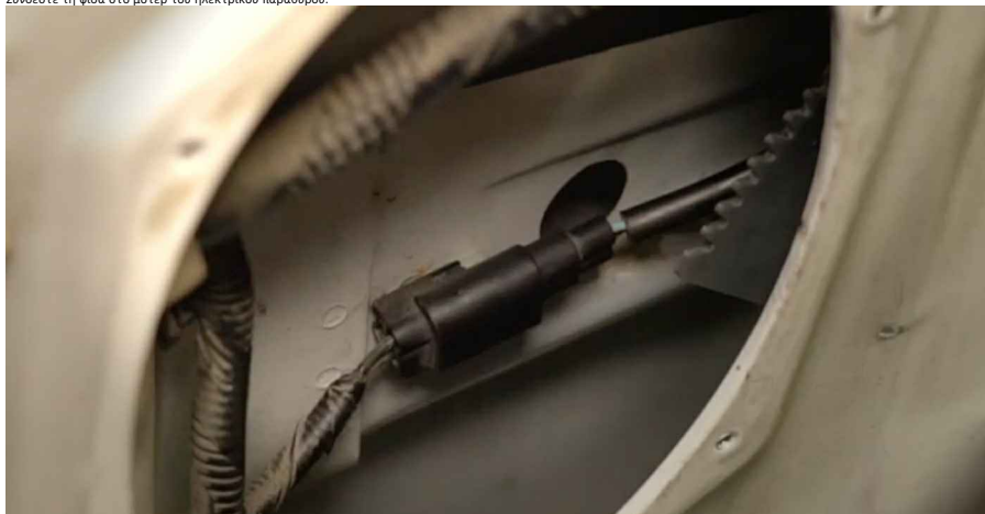
24 Τοποθετήστε το μπουλόνι στερέωσης της ράγας οδηγού παραθύρου.
