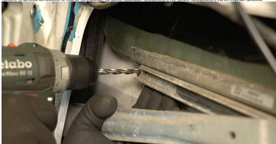
14 Τρυπήστε τα πριτσίνια που συνδέουν τον μηχανισμό του γρόλου παραθύρων με την πόρτα. Χρησιμοποιήστε ένα τρυπάνι. Χρησιμοποιήστε ένα σετ κεφαλών τρυπανιού.
