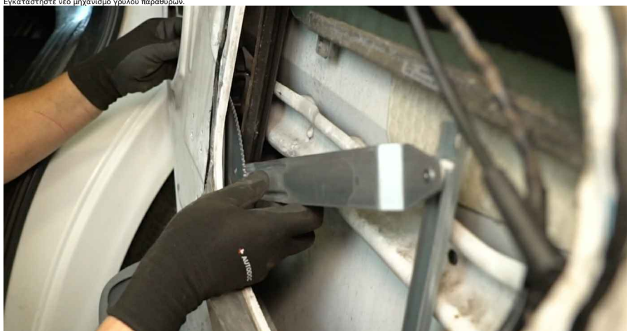
21 Τοποθετήστε τα μπουλόνια στερέωσης.
