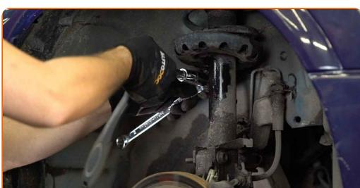
**8** Καθαρίστε τα στοιχεία στερέωσης των μπαρακιών της αντιστρεπτικής δοκού. Χρησιμοποιήστε μια συρματόβουρτσα. Χρησιμοποιήστε σπρέι WD-40.
