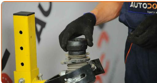
**27** Σφίξτε το παξιμάδι της ράβδου του εμβόλου του γονάτου του αμορτισέρ. Χρησιμοποιήστε ένα καρυδάκι #20. Χρησιμοποιήστε ένα δυναμόκλειδο. Σφίξτε τη με ροπή 60 Nm.
