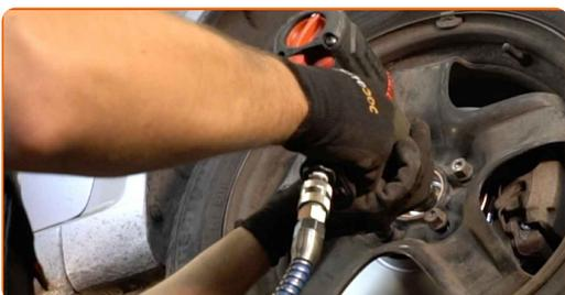
**32** Χαμηλώστε το αυτοκίνητο και χρησιμοποιήστε σταυρό, προκειμένου να σφίξετε τα μπουλόνια των τροχών. Χρησιμοποιήστε κρουστικό καρυδάκι για μπουλονόκλειδο Νο #17. Χρησιμοποιήστε ένα δυναμόκλειδο. Σφίξτε τη με ροπή 110 Nm.
