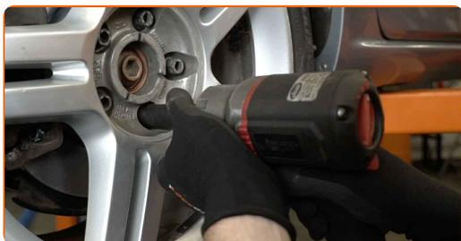
**22** Χαμηλώστε το αυτοκίνητο και χρησιμοποιήστε σταυρό, προκειμένου να σφίξετε τα μπουλόνια των τροχών. Χρησιμοποιήστε κρουστικό καρυδάκι για μπουλονόκλειδο Νο #19. Χρησιμοποιήστε ένα δυναμόκλειδο. Σφίξτε τη με ροπή 108 Nm.
