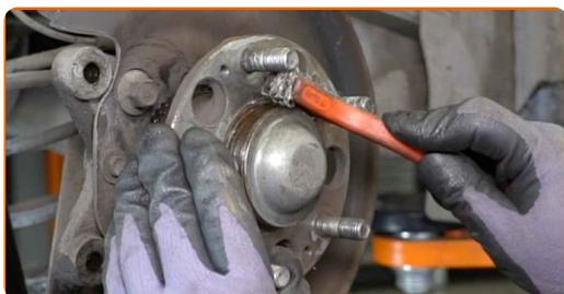
**25** Καθαρίστε το σημείο επαφής. Χρησιμοποιήστε κεραμικό γράσο.
