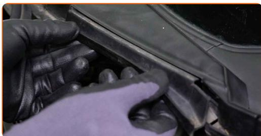
**49** Τοποθετήστε την τσιμούχα του τροπέτου των υαλοκαθαριστήρων.
