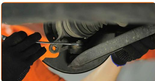
23 Αποσυνδέστε το κάτω ψαλίδι από το μουαγιε. Χρησιμοποιήστε ένα λοστό. Χρησιμοποιήστε μια λαστιχένια ματσόλα.
