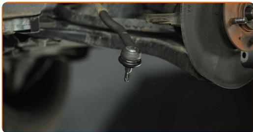
21 Καθαρίστε τους συνδέσμους που συνδέει το ακρόμπαρο με το μουαγιέ τροχού. Χρησιμοποιήστε μια συρματόβουρτσα. Χρησιμοποιήστε σπρέι WD-40.
