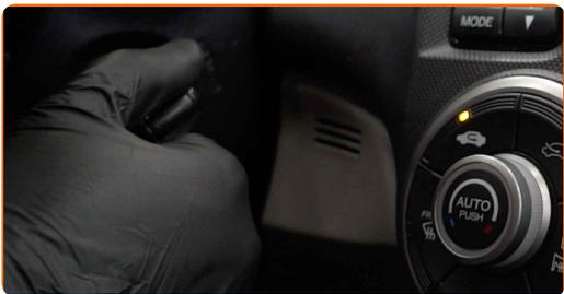
**10** Ενεργοποιήστε το σύστημα κλιματισμού. Αυτό απαιτείται για να διασφαλιστεί ότι το τμήμα θα λειτουργήσει σωστά.
