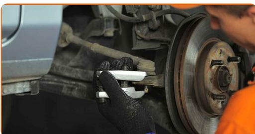
**11** Καθαρίστε το περικόχλιο ασφάλισης που συνδέει τη μπάρα διεύθυνσης με το ακρόμπαρο διεύθυνσης. Χρησιμοποιήστε μια συρματόβουρτσα. Χρησιμοποιήστε σπρέι WD-40.
