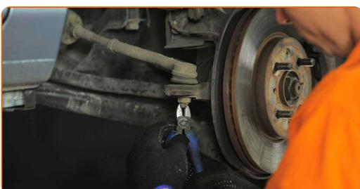
**8** Καθαρίστε το στοιχείο στερέωσης που συνδέει το μπαλάκι του ακρόμπαρου με το μπουαγιέ. Χρησιμοποιήστε μια συρματόβουρτσα. Χρησιμοποιήστε σπρέι WD-40.
