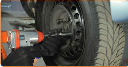
**25** Χαμηλώστε το αυτοκίνητο και χρησιμοποιήστε σταυρό, προκειμένου να σφίξετε τα μπουλόνια των τροχών. Χρησιμοποιήστε κρουστικό καρυδάκι για μπουλονόκλειδο No #19. Χρησιμοποιήστε ένα δυναμόκλειδο. Σφίξτε τη με ροπή 108 Nm.
