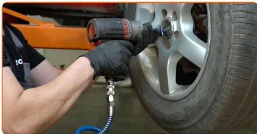
**19** Χαμηλώστε το αυτοκίνητο και χρησιμοποιήστε σταυρό, προκειμένου να σφίξετε τα μπουλόνια των τροχών. Χρησιμοποιήστε κρουστικό καρυδάκι για μπουλονόκλειδο No #17. Χρησιμοποιήστε ένα δυναμόκλειδο. Σφίξτε τη με ροπή 120 Nm.
