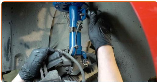
**12** Σφίξτε το στοιχείο στερέωσης που συνδέει το μπαράκι της αντιστρεπτικής στο γόνατο του αμορτισέρ. Χρησιμοποιήστε ένα γερμανοπολύγωνο #17. Χρησιμοποιήστε ένα καρυδάκι #17. Χρησιμοποιήστε ένα δυναμόκλειδο. Σφίξτε τη με ροπή 40 Nm.
