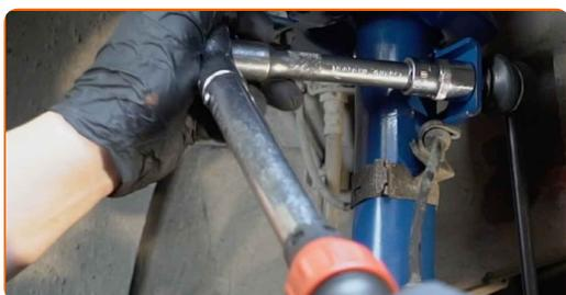
**13** Σφίξτε το στοιχείο στερέωσης που συνδέει το μπαράκι της αντιστρεπτικής στην αντιστρεπτική δοκό. Χρησιμοποιήστε ένα γερμανοπολύγωνο #17. Χρησιμοποιήστε ένα καρυδάκι #17. Χρησιμοποιήστε ένα δυναμόκλειδο. Σφίξτε τη με ροπή 40 Nm.
