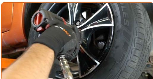
**19** Χαμηλώστε το αυτοκίνητο και χρησιμοποιήστε σταυρό, προκειμένου να σφίξετε τα μπουλόνια των τροχών. Χρησιμοποιήστε κρουστικό καρυδάκι για μπουλονόκλειδο Νο #17. Χρησιμοποιήστε ένα δυναμόκλειδο. Σφίξτε τη με ροπή 98 Nm.
