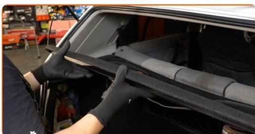
**3** Ξεβιδώστε τα στοιχεία στερέωσης του πλευρικού πλαστικού πάνελ της ταπετσαρίας. Χρησιμοποιήστε ένα καρυδάκι #10. Χρησιμοποιήστε μια καστάνια.
