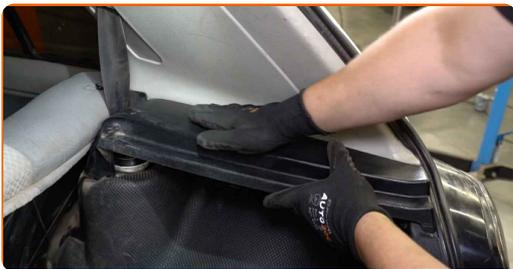
**55** Βιδώστε τα στοιχεία στερέωσης του πλευρικού πλαστικού πάνελ της ταπετσαρίας. Χρησιμοποιήστε ένα καρυδάκι #10. Χρησιμοποιήστε μια κασάνια.
