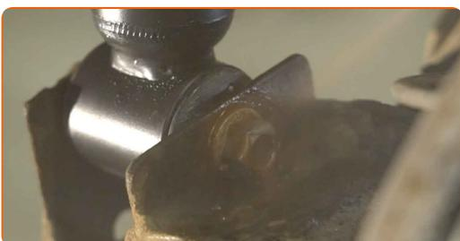
**46** Καθαρίστε το σημείο τοποθέτησης της ζάντας του τροχού. Χρησιμοποιήστε μια συρματόβουρτσα.
