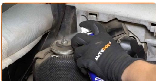
**6** Χαλαρώστε το επάνω στοιχείο στερέωσης της βάσης του γόνατου του αμορτισέρ. Χρησιμοποιήστε ένα γερμανοπολύγωνο #17. Χρησιμοποιήστε ένα καρυδάκι αμορτισέρ DD5,2. Χρησιμοποιήστε μια καστίνα.
