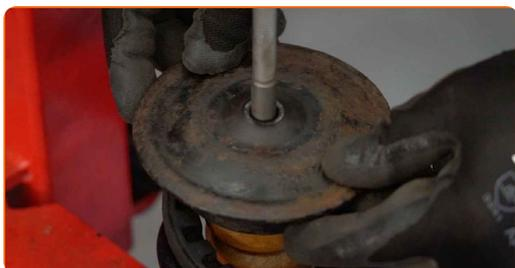
**33** Σφίξτε το παξιμάδι της ράβδου του εμβόλου του γονάτου του αμορτισέρ. Χρησιμοποιήστε ένα γερμανοπολύγωνο #17. Χρησιμοποιήστε ένα καρυδάκι αμορτισέρ DD5,2. Χρησιμοποιήστε ένα δυναμόκλειδο. Σφίξτε τη με ροπή 35 Nm.
