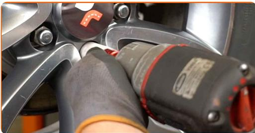
**41** Χαμηλώστε το αυτοκίνητο και χρησιμοποιήστε σταυρό, προκειμένου να σφίξετε τα μπουλόνια των τροχών. Χρησιμοποιήστε κρουστικό καρυδάκι για μπουλονόκλειδο No #21. Χρησιμοποιήστε ένα δυναμόκλειδο. Σφίξτε τη με ροπή 118 Nm.
