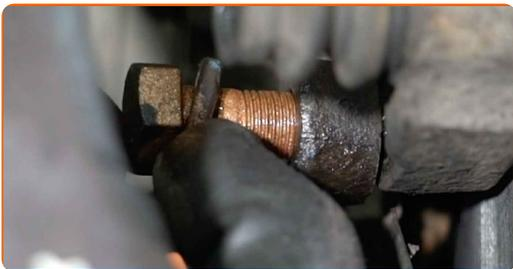
**27** Σφίξτε τα στοιχεία στερέωσης του βραχίονα στήριξης της δαγκάνας φρένων. Χρησιμοποιήστε ένα καρυδάκι #19. Χρησιμοποιήστε ένα δυναμόκλειδο. Σφίξτε τη με ροπή 80 Nm.
