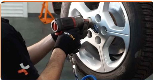
**24** Χαμηλώστε το αυτοκίνητο και χρησιμοποιήστε σταυρό, προκειμένου να σφίξετε τα μπουλόνια των τροχών. Χρησιμοποιήστε ένα δυναμόκλειδο. Σφίξτε τη με ροπή 108 Nm.
