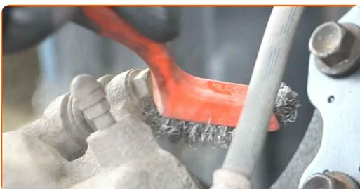
**9** Ξεβιδώστε τα στοιχεία στερέωσης της δαγκάνας φρένων. Χρησιμοποιήστε ένα καρυδάκι #14. Χρησιμοποιήστε μια καστίνα.
