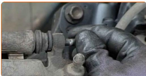
**22** Σφίξτε τα στοιχεία στερέωσης της δαγκάνας του φρένου. Χρησιμοποιήστε ένα καρυδάκι #14. Χρησιμοποιήστε ένα δυναμόκλειδο. Σφίξτε τη με ροπή 32 Nm.
