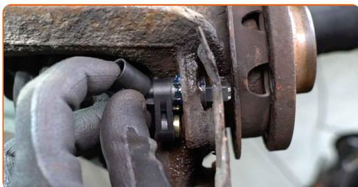
**21** Σφίξτε το στοιχείο στερέωσης που συνδέει τον αισθητήρα ABS με το ακραξόνιο. Χρησιμοποιήστε ένα Άλεν Νο. H5. Χρησιμοποιήστε ένα δυναμόκλειδο. Σφίξτε τη με ροπή 6 Nm.
