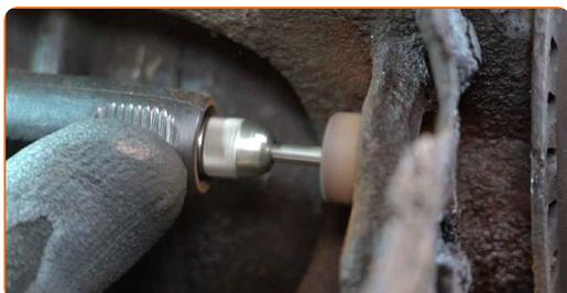
**19** Επεξεργαστείτε το στοιχείο στερέωσης του αισθητήρα ABS. Χρησιμοποιήστε γράσο γενικής χρήσης.
