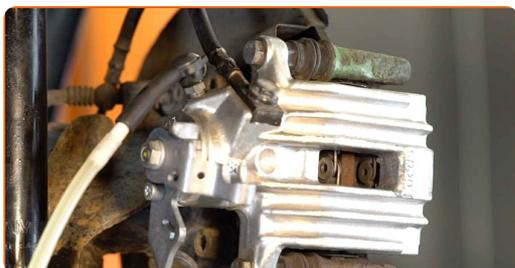
**26** Τοποθετήστε τη ντίζα του χειρόφρενου στη βάση της δαγκάνας του φρένου. Χρησιμοποιήστε μια γκαζοτανάλια.
