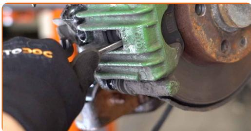
**14** Ξεβιδώστε τον σφιγκτήρα της δαγκάνας των φρένων. Χρησιμοποιήστε ένα γερμανοπολύγωνο #15. Χρησιμοποιήστε ένα καρυδάκι #13. Χρησιμοποιήστε μια καστίνα.
