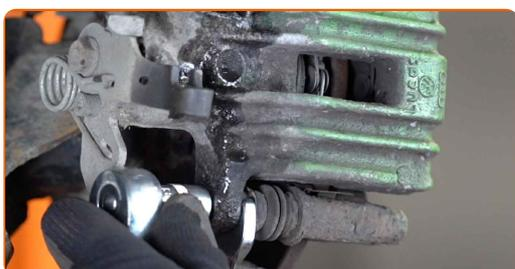
**15** Αφαιρέστε τη δαγκάνα του φρένου. Χρησιμοποιήστε ένα λοστό.
