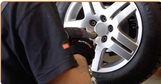
37 Χαμηλώστε το αυτοκίνητο και χρησιμοποιήστε σταυρό, προκειμένου να σφίξετε τα μπουλόνια των τροχών. Χρησιμοποιήστε ένα δυναμόκλειδο. Σφίξτε τη με ροπή 120 Nm.
