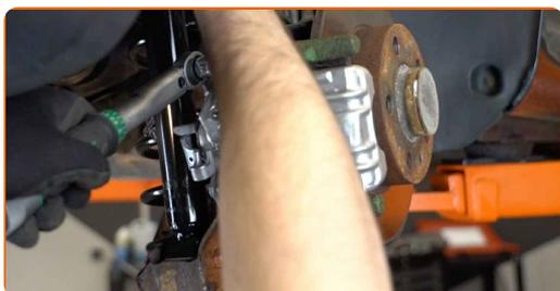
**18** Ξεβιδώστε το άκρο του μαρκουτσιού του φρένου. Χρησιμοποιήστε ένα Άλεν No.H6 Χρησιμοποιήστε μια καστάνια.
