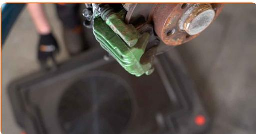
**12** Ξεβιδώστε τη σωλήνα των φρένων από τη δαγκάνα των φρένων. Χρησιμοποιήστε ένα καρυδάκι #13. Χρησιμοποιήστε μια καστανία.
