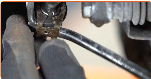
**9** Αποσυνδέστε τη ντίζα του χειρόφρενου από τη δαγκάνα. Χρησιμοποιήστε μια γκαζοτανάλια. Ελευθερώστε τη ντίζα του χειρόφρενου.
