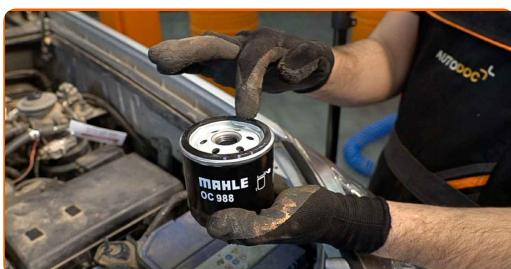
**19** Βιδώστε το φίλτρο στη θέση του. Χρησιμοποιήστε ένα καρυδάκι 76-14F. Χρησιμοποιήστε ένα δυναμόκλειδο. Σφίξτε τη με ροπή 20 Nm.
