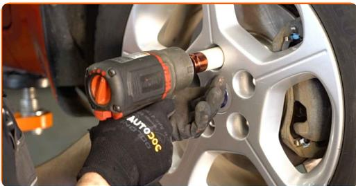
**30** Χαμηλώστε το αυτοκίνητο και χρησιμοποιήστε σταυρό, προκειμένου να σφίξετε τα μπουλόνια των τροχών. Χρησιμοποιήστε ένα δυναμόκλειδο. Σφίξτε τη με ροπή 108 Nm.
