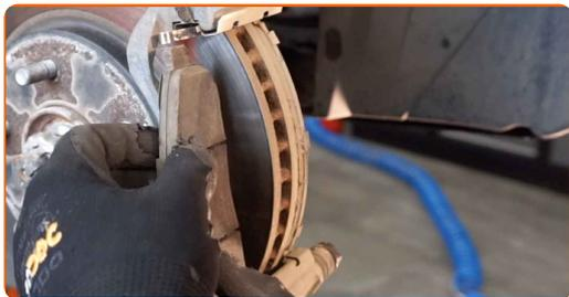
**11** Αφαιρέστε τα ελατήρια συγκράτησης των τακακιών των φρένων. Χρησιμοποιήστε ένα λοστό.
