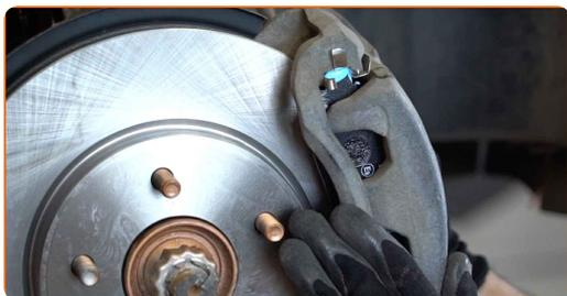
**25** Σφίξτε τη βάση της δαγκάνας των φρένων. Χρησιμοποιήστε ένα καρυδάκι #19. Χρησιμοποιήστε ένα δυναμόκλειδο. Σφίξτε τη με ροπή 165 Nm.
