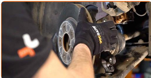
**22** Καθαρίστε την πλήμνη. Χρησιμοποιήστε μια συρματόβουρτσα. Καθαρίστε το σημείο επαφής. Χρησιμοποιήστε γράσο χαλκού.
