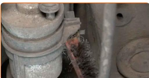
**6** Ξεσφίξτε τα στοιχεία στερέωσης του φίλτρου καυσίμου. Χρησιμοποιήστε ένα σταυροκατσάβιδο.
