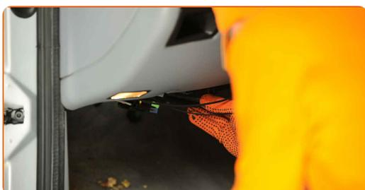
**9** Τοποθετήστε και ασφαλίστε την ταπετσαρία κάτω από τον πίνακα οργάνων. Χρησιμοποιήστε ένα Τορξ T25.
