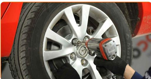
**41** Χαμηλώστε το αυτοκίνητο και χρησιμοποιήστε σταυρό, προκειμένου να σφίξετε τα μπουλόνια των τροχών. Χρησιμοποιήστε κρουστικό καρυδάκι για μπουλονόκλειδο Νο #19. Χρησιμοποιήστε ένα δυναμόκλειδο. Σφίξτε τη με ροπή 118 Nm.
