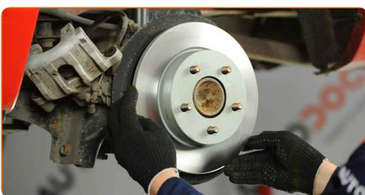
**21** Καθαρίστε τη βάση της δαγκάνας των φρένων από τη βρωμιά και τη σκόνη. Χρησιμοποιήστε μια συρματόβουρτσα. Χρησιμοποιήστε καθαριστικό φρένων.
