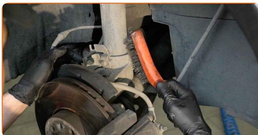
**13** Ξεβιδώστε το κάτω στοιχείο στερέωσης που συνδέει το γόνατο του αμορτισέρ με το μουαγιέ. Χρησιμοποιήστε ένα καρυδάκι #17. Χρησιμοποιήστε μια καστάνια.
