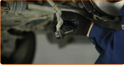
**14** Καθαρίστε τις βάσεις τοποθέτησης του ακρόμπαρου. Χρησιμοποιήστε μια συρματοβούρτσα. Χρησιμοποιήστε σπρέι WD-40
