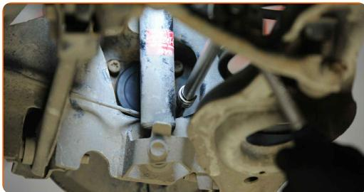
**35** Επεξεργαστείτε τον ακροδέκτη του αισθητήρα ABS. Χρησιμοποιήστε σπρέι ηλεκτρικών επαφών.
