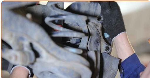
**37** Περάστε από επεξεργασία το τμήμα της πλήμνης του τροχού που έρχεται σε επαφή με το δίσκο του φρένου. Χρησιμοποιήστε γράσο χαλκού.
