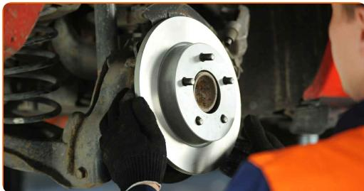
**18** Καθαρίστε τα στοιχεία στερέωσης του ρουλεμάν της πλήμνης του τροχού. Χρησιμοποιήστε μια συρματόβουρτσα. Χρησιμοποιήστε σπρέι WD-40.
