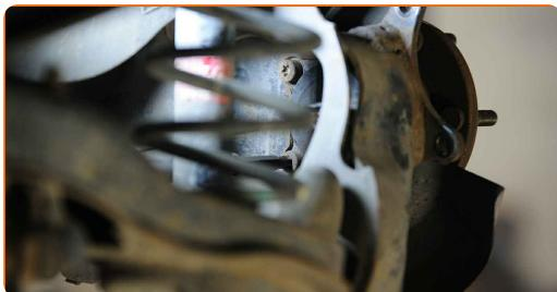
**19.2** Χρησιμοποιήστε ένα Τορξ T50. Χρησιμοποιήστε μια καστάνια.
