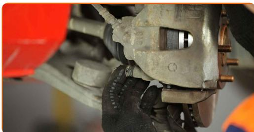
**36** Τοποθετήστε την ασφάλεια στη δαγκάνα. Χρησιμοποιήστε ένα μυτοσίμπιδο. Χρησιμοποιήστε ένα ίσιο κατσαβίδι.
