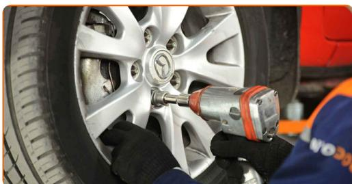
**41** Χαμηλώστε το αυτοκίνητο και χρησιμοποιήστε σταυρό, προκειμένου να σφίξετε τα μπουλόνια των τροχών. Χρησιμοποιήστε κρουστικό καρυδάκι για μπουλονόκλειδο No #19. Χρησιμοποιήστε ένα δυναμόκλειδο. Σφίξτε τη με ροπή 118 Nm.
