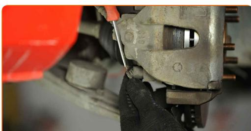
**9** Καθαρίστε τα στοιχεία στερέωσης της δαγκάνας των φρένων. Χρησιμοποιήστε μια συρματόβουρτσα. Χρησιμοποιήστε σπρέι WD-40.
