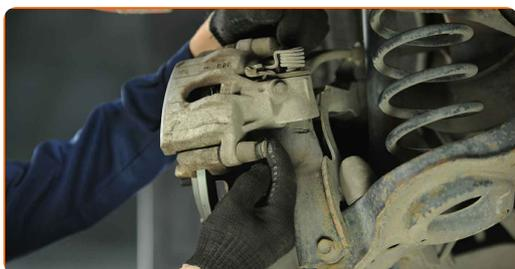
**25** Τοποθετήστε την ασφάλεια στη δαγκάνα. Χρησιμοποιήστε ένα ίσιο κατσαβίδι.
