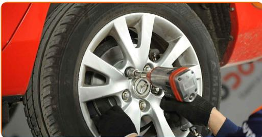
**30** Χαμηλώστε το αυτοκίνητο και χρησιμοποιήστε σταυρό, προκειμένου να σφίξετε τα μπουλόνια των τροχών. Χρησιμοποιήστε κρουστικό καρυδάκι για μπουλονόκλειδο No #19. Χρησιμοποιήστε ένα δυναμόκλειδο. Σφίξτε τη με ροπή 118 Nm.
